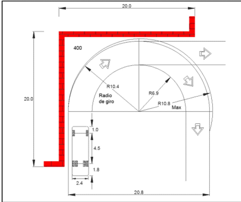
Figura 2. Radio de giro 12.20 -12.56 m para una superficie de 400 m<sup>2</sup>, en esquina.
