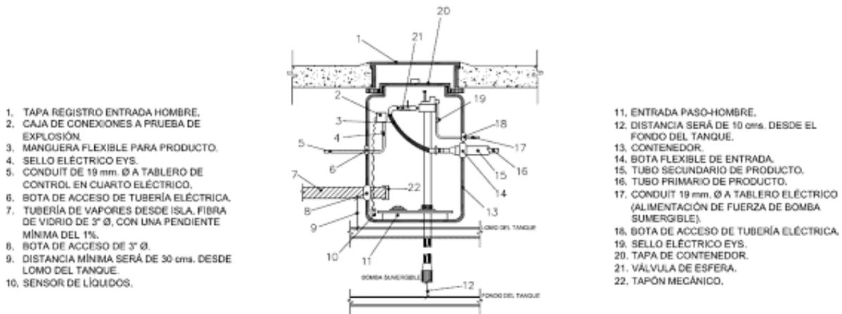
NOTA: LA TUBERÍA DE VAPORES SE INSTALARÁ DE ESTA FORMA CUANDO NO EXISTA OPERANDO UN SISTEMA DE RECUPERACIÓN DE VAPORES.
